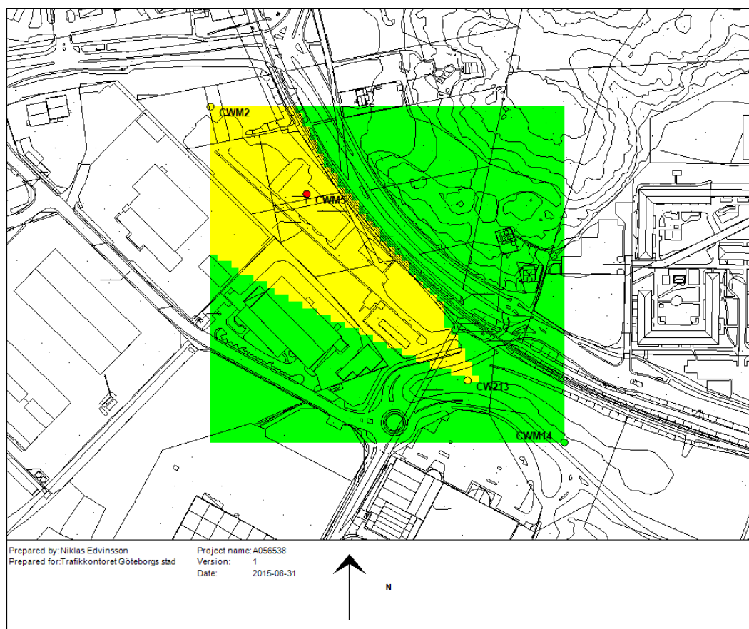
Figur 3. Uppskattning av mängd förorenad mark 2-3 m under befintlig markyta. Grönt = <MKM, gult = KM-MKM och rött = >MKM.
